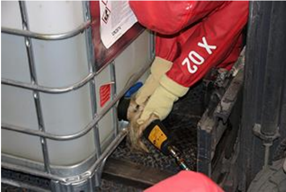
Auffangen und Abdichten des Schadstoffaustritts am Gefahrgutcontainer
