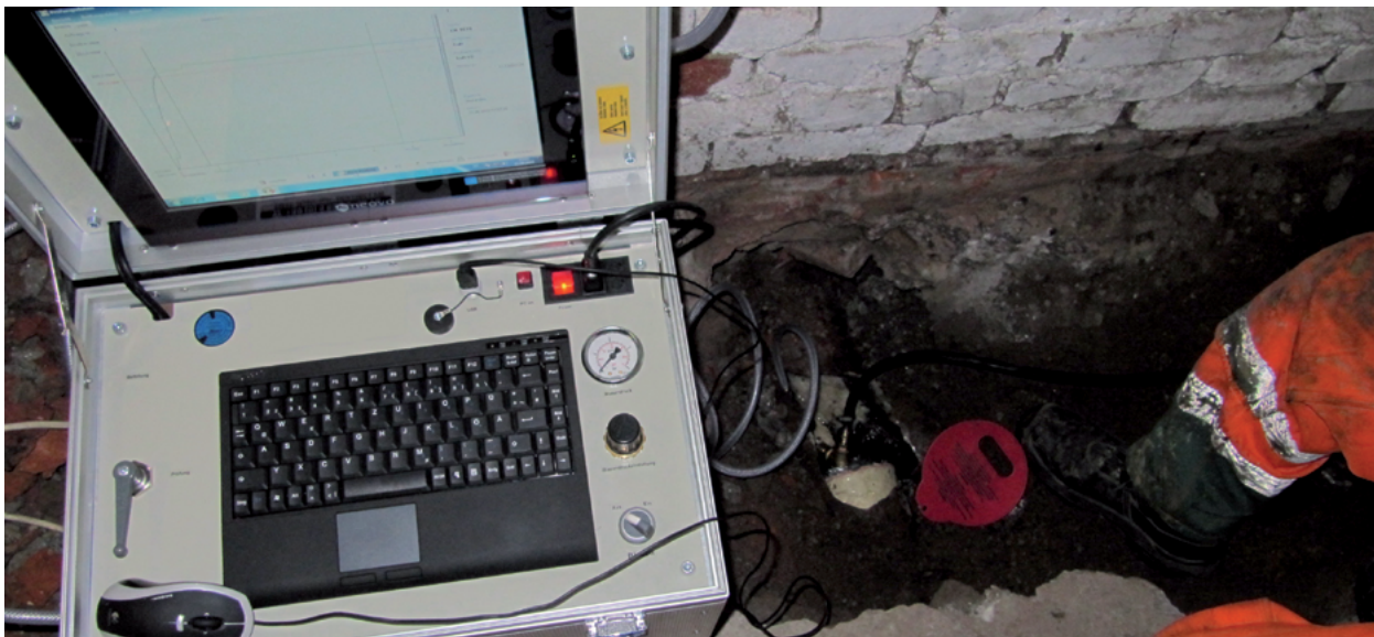
Druckverlustmessung bei der Dichtheitsprüfung mit Luftdruck
