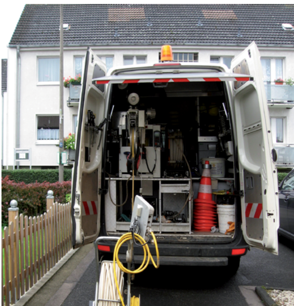
TV-Inspektionsfahrzeug im Einsatz
